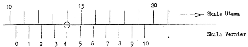
Gambar 2 Pembacaan mistar geser dengan ketelitian 0,1 mm
